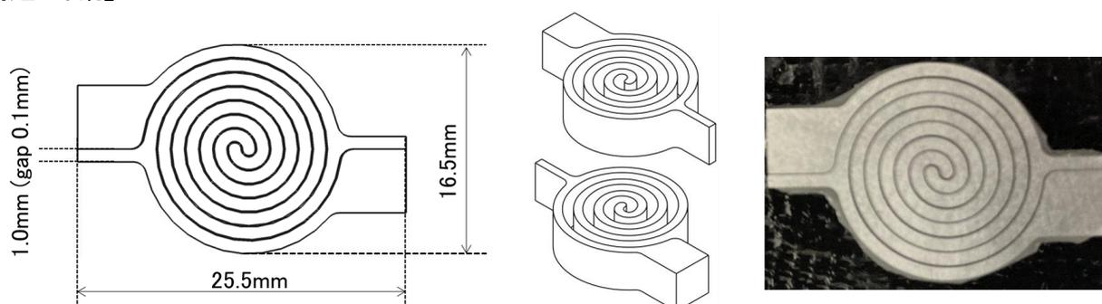
電極幅を1mmとした渦巻形状における回転方向の動きを抑制するためのフランジ構造を有し電極間距離を0.1mmとしています。この形状により、取り付け角度の方向依存性がなくなり、また、腐食挙動を平均的に捉えられます。電極間の隙間にはエポキシ樹脂を充填し、事前に金属の表面処理を行うことによって、すき間腐食の発生を抑制しています。
