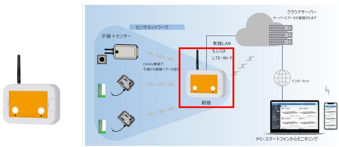
ACアダプタ、もしくは12Vバッテリーで稼働できます。外部電源がない場合はバッテリーと太陽光発電システムを組み合わせることでバッテリーの充電作業が不要になります。屋外で使用する場合は、別売りの防水ボックスをご活用ください。
