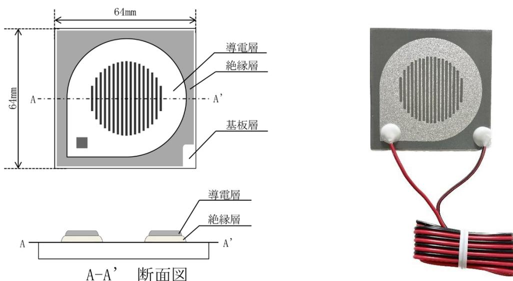
基板となる対象金属(Fe、亜鉛メッキ鋼板など)の上に、絶縁ペストをスクリーン印刷・焼成硬化し、さらにその上に基板との絶縁が保たれるように導電性ペスト(Ag など)を積層印刷・焼成硬化します。乾燥状態で両極間の抵抗が  $1G\Omega$  以上のものをセンサとして用います。
