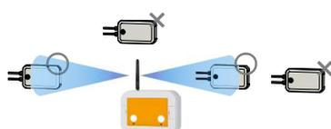
棒アンテナの電波方向イメージ
