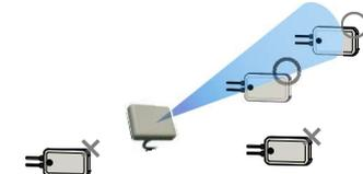
指向性アンテナの電波方向イメージ
